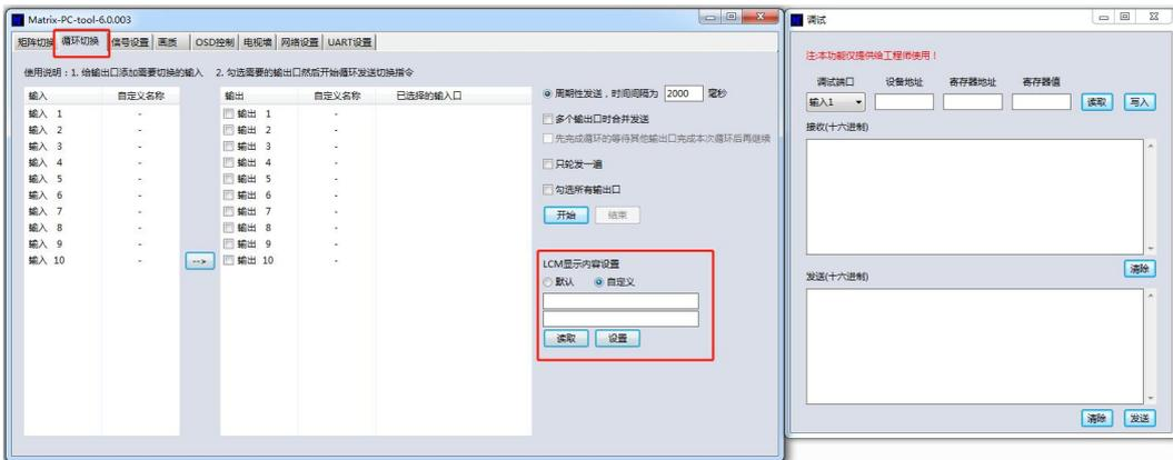
LCM 每行最多只能显示 20 个字符。通过空格来进行居中显示
